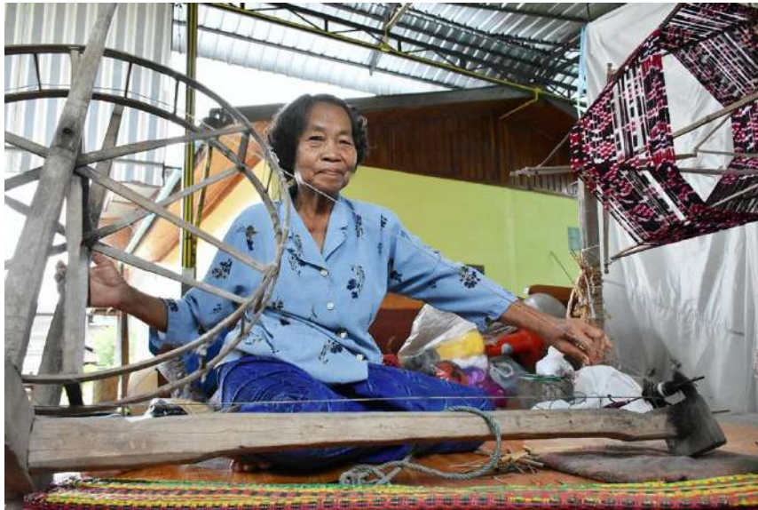
การนำเส้นด้ายออกจากกงให้มาอยู่ในหลอดกระสวย
