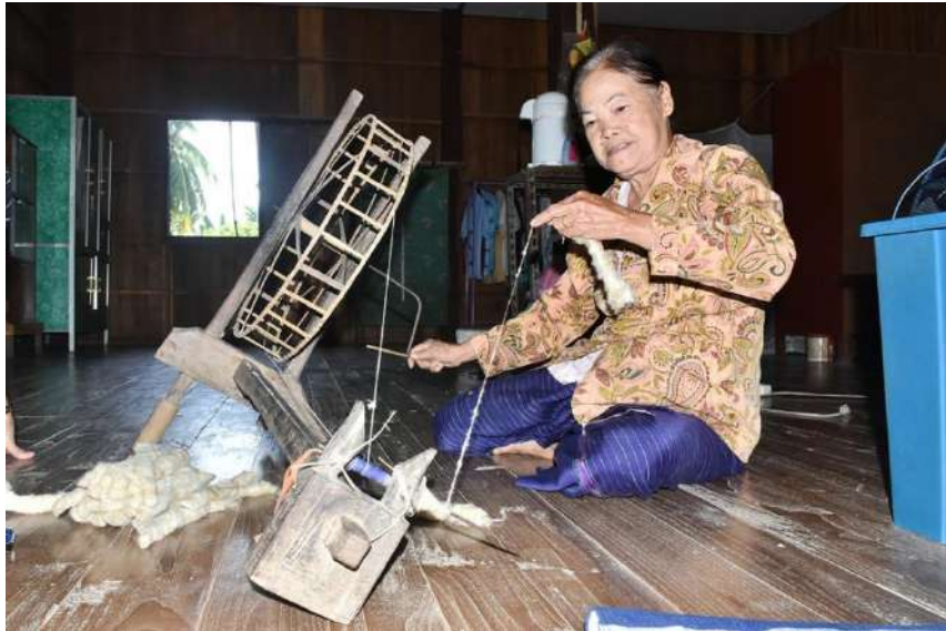
การเส้นฝ้ายให้เป็นเส้นด้วยอุปกรณ์ “หลา”
